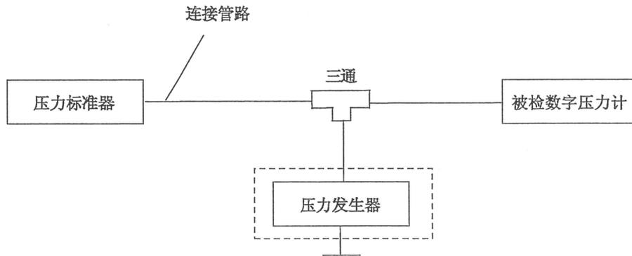
图 2 压力计的示值误差检定连接示意图
