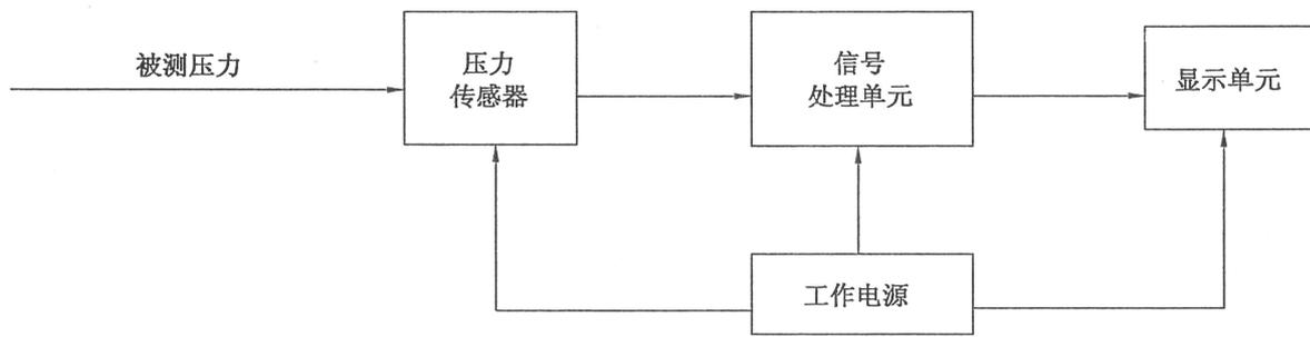
图 1 数字压力计工作原理示意图
